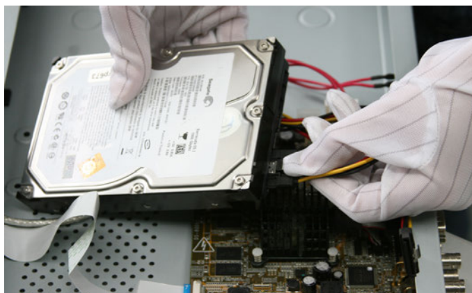
Рисунок 2-3 Подключение кабеля питания
